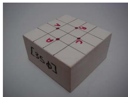
Afb. 6 Meting van de dikte op vier punten van de oppervlakte van een proefstuk dat onderworpen wordt aan de Amsler-proef.
