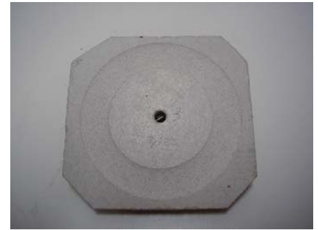
Afb. 8 Cementmonster onderworpen aan de Taber-proef.
