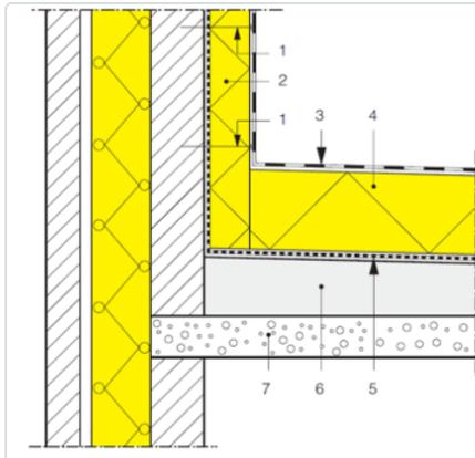
1. Fixation mécanique de l'isolation du relevé
